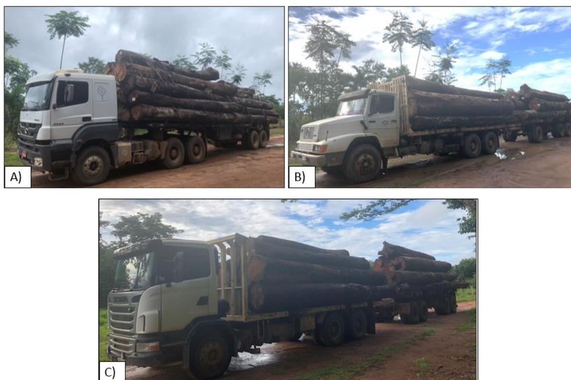
Figura 4. Composições Veiculares de Carga (CVCs) usadas. A) Cavalo Mecânico com semi-reboque; B) Biminhão; C) Biminhão.
